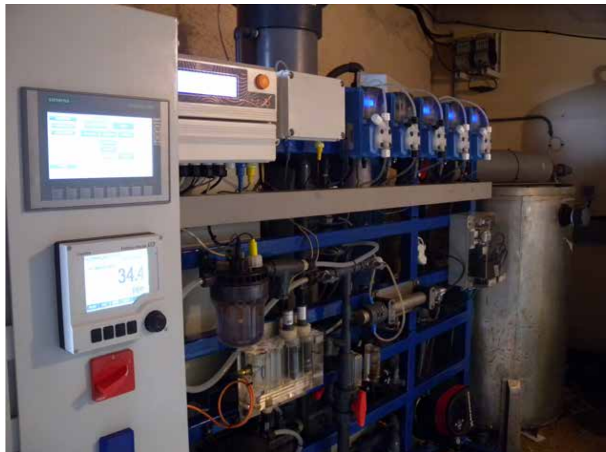
Mòdul d'electrodenitrificació - prova pilot a petita escala que s'està realitzant actualment a Caldes de Malavella.
